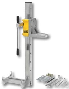
**REMS Simplex 2.** Colonne de carottage robuste et maniable pour travaux de carottage jusqu'à Ø 202 mm. Avec outils, comprenant clé six pans mâle de 6, clés plates de 19 et 30 et set de fixation pour maçonnerie et béton, comprenant 2 chevilles écarteurs M12 pour maçonnerie, 10 chevilles d'ancrage M12 pour béton, chasse pour cheville d'ancrage M12, tige filetée à moletage M12×52, écrou à serrage rapide, rondelle, foret en métal dur pour la pierre Ø 15 mm SDS-plus. Dans boîte carton.
