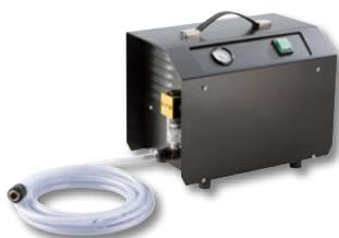
**Pompe à vide** pour vide  $\leq -900$  mbar (90%), comprenant pompe à sec à obturateur tournant, sans huile, débit 6 m<sup>3</sup>/h, moteur à condensateur 230 V, 50-60 Hz, 250 W, protection contre les projections d'eau, filtre d'aspiration intérieur avec insonorisation et tuyau tressé en PVC, 5 m, avec raccord rapide. Code 183670 R220
